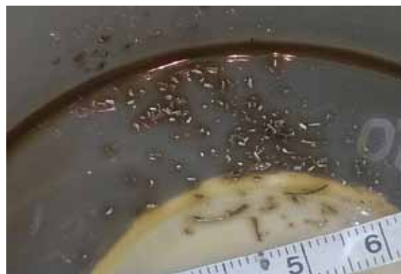
Металлическая стружка в моторном масле Range Rover – турбодизель, 3 литра, 298 л.с., пробег 15000 км.
